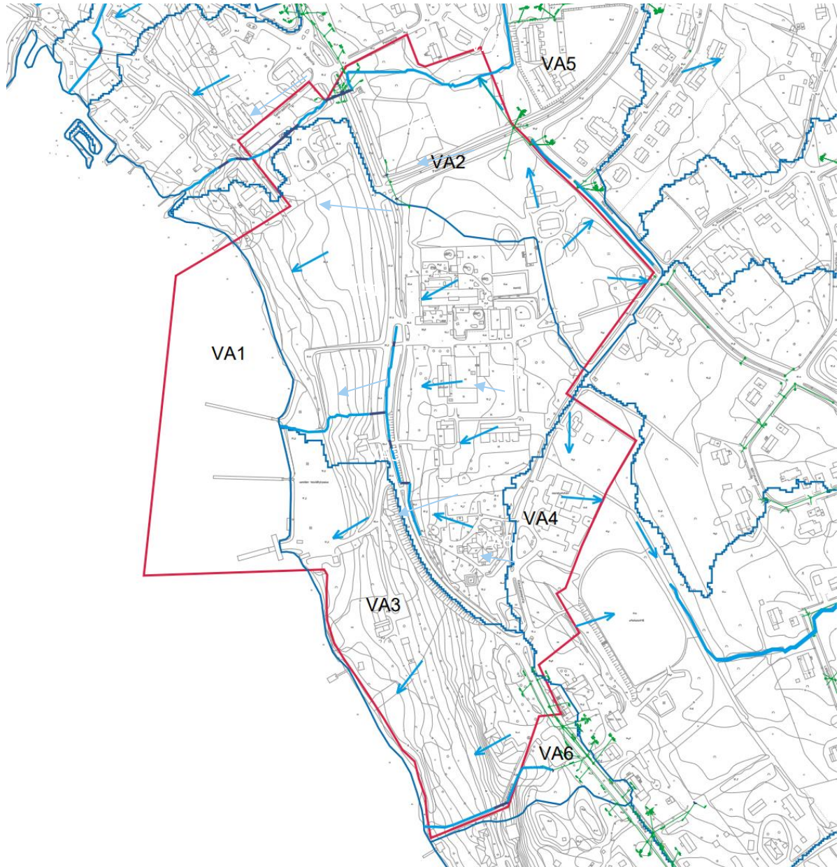
Kuva 8 Osavaluma-alueet VA1-VA6 (sininen rajaus) sekä hulevesien virtassuunnat niiden sisällä. suunnittelualueen rajaus on punaisella.
